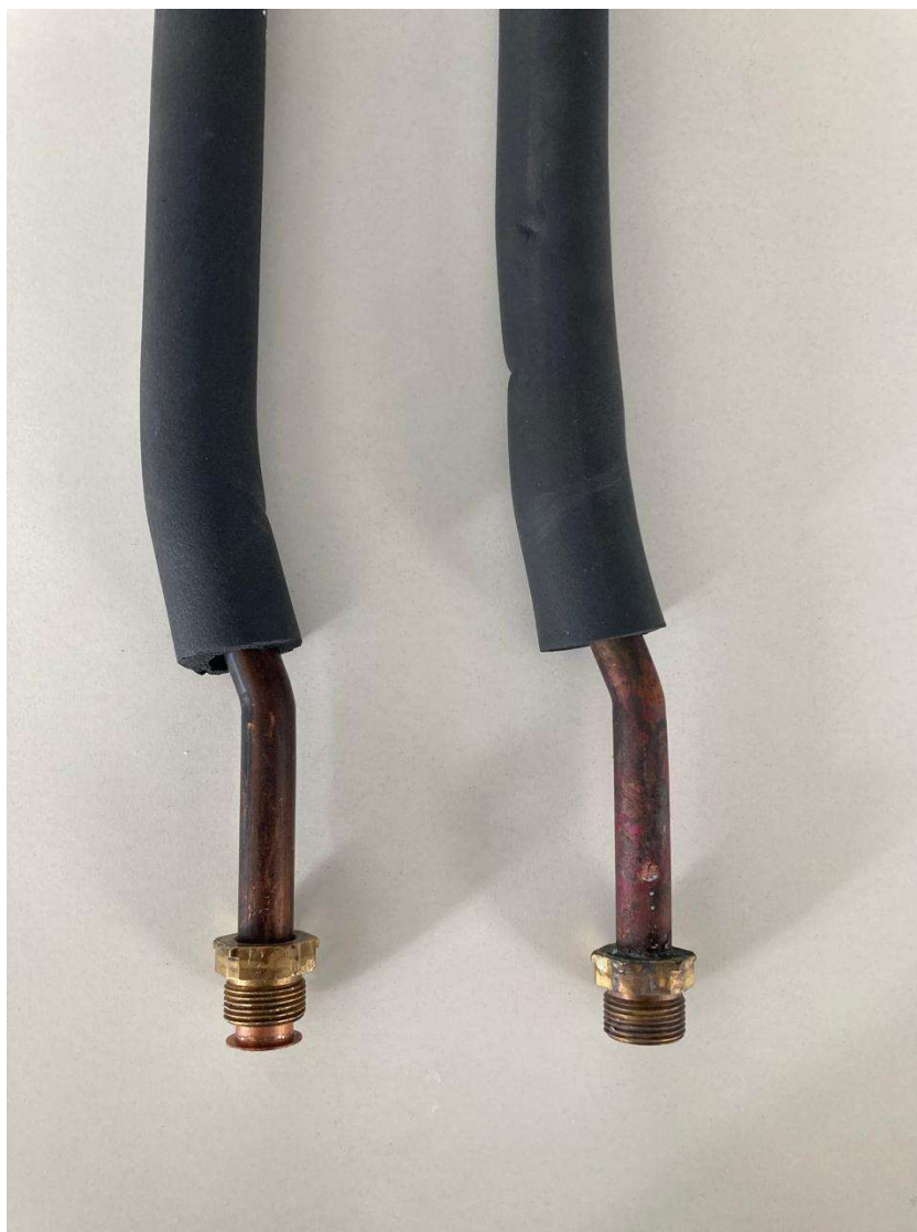
Рис. 1 Слева трубка подачи нового образца с развальцованной медной трубкой.
